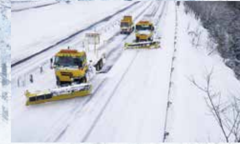
本線除雪作業 (冬期間) 一定距離で隊列を組み、路面が均一になるよう作業を行います。
