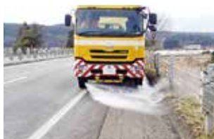
散水車による路面清掃
